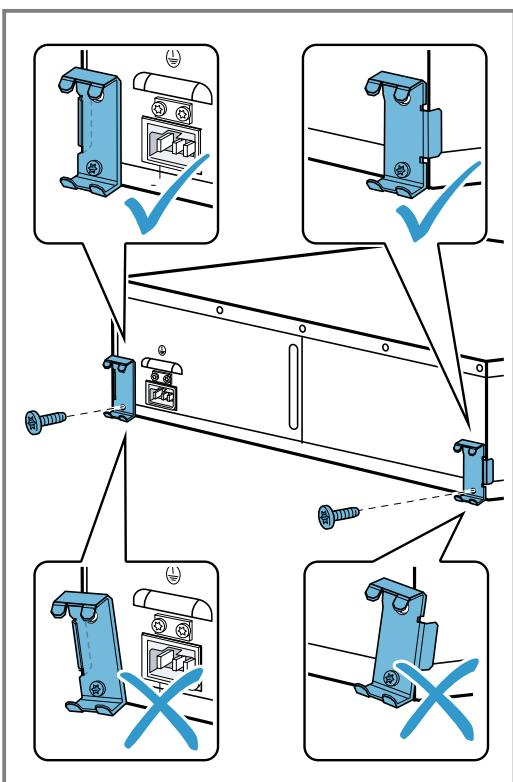
6. Uredaj stavite u ugradni orman i proverite da li zaštića od prevrtanja uskače.
