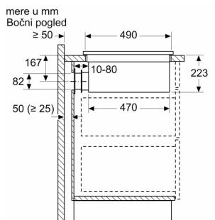
Prilikom montaže neposredno uz spoljašnje zidove koji nisu izolovani ( $\mu \geq 0,5 \text{ W/m}^2 \text{ °C}$ ), preporučujemo da koristite konfiguracije za recikulaciju koje delimično ili potpuno prolaze kroz cevi.
