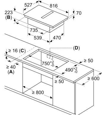
**A:** Najmanje rastojanje od isečka ploče za kuvanje do zida
