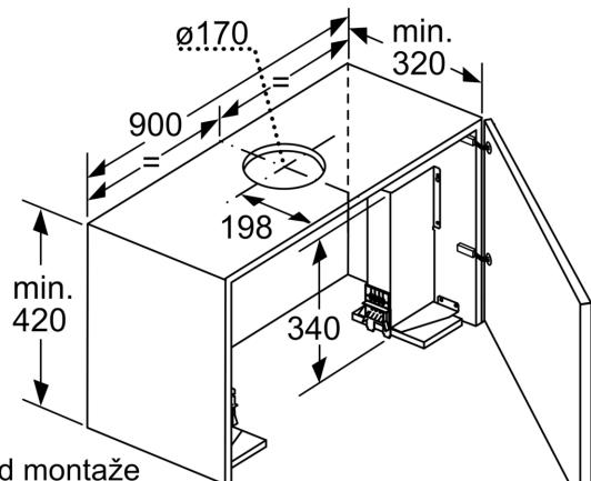
Kod montaže ravnog ugradnog aspiratora od 90 cm u gornji kuhinjski element širine 90 cm potreban je set za montažu. Oba nosača za montažu treba zašrafiti u element nameštaja sa desne i leve strane. Montaža prema šablonu.
