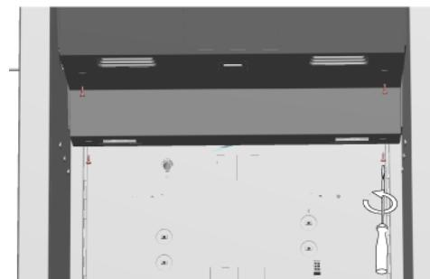
3. 1. Na uvoľnenie krytu odparovača z úchytiak potiahnite kryt horizontálne (1).
