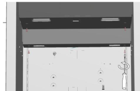
3. 1. Die Verdampferabdeckung in horizontaler Richtung ziehen, um sie aus den Clips zu lösen (1).
