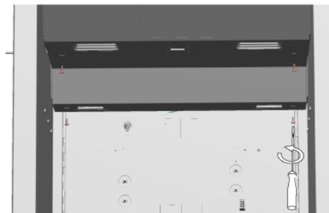
1. Puxe a tampa do evaporador na direção horizontal para libertá-la dos clipe (1).
