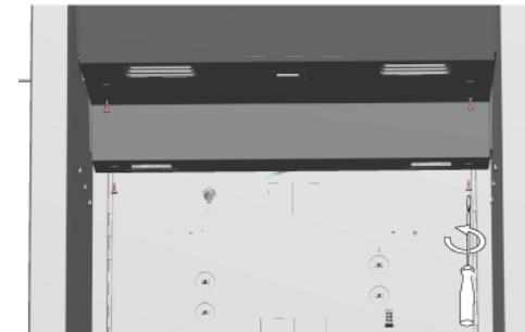
3. 1. Trek de verdamperafdekking in horizontale richting om deze los te halen van de clips (1).
