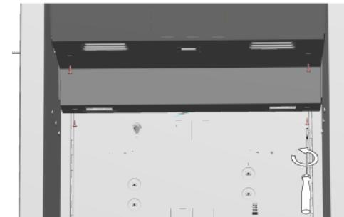
3. 1. Pociągnąć pokrywę parownika w kierunku poziomym, aby zwolnić jej zaczepy (1).
